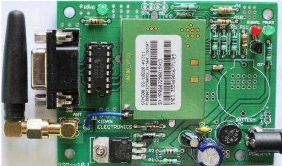
Fig. 2: SIM300 GSM module
